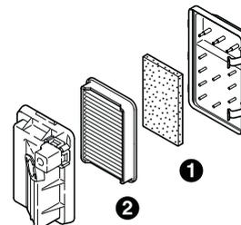
Nettoyer et changer plus souvent les éléments du filtre à air si le moteur est utilisé en environnement
