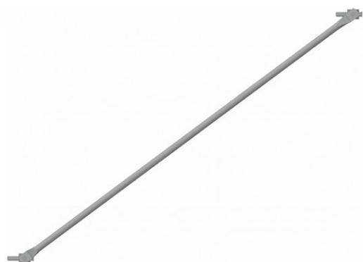
Fabriquées avec un tube de  $\varnothing$  40 mm, elles sont munies de colliers tournants de  $\varnothing$  45 mm sur leurs deux extrémités. Leur rôle est de stabiliser les plans verticaux formés par les montants des cadres.
