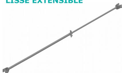
Fabriquée avec un tube extérieur de  $\varnothing$  35 mm et intérieur de  $\varnothing$  30 mm, elle est munie sur les deux extrémités de colliers pour tube de  $\varnothing$  45 mm à bloqueur, qui permettent de l'assembler rapidement sur n'importe quel type de cadre. Fixation de la partie extensible à l'aide du bloqueur pour tube de 30 mm. Galvanisé à chaud avec une épaisseur minimale de 75 microns.
