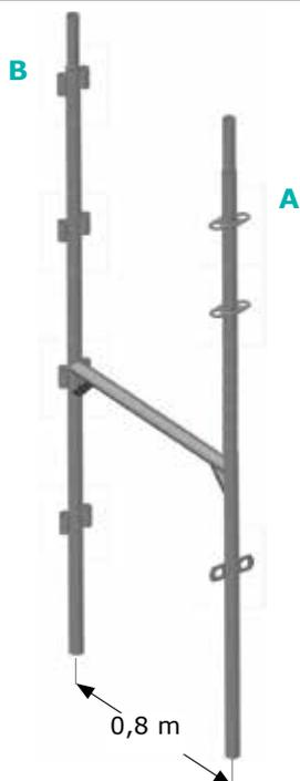
Il s'agit des éléments du système destinés à supporter le poids de l'échafaudage. Ils sont fabriqués avec un tube de  $\varnothing 45 \times 2$  mm d'épaisseur. Partie supérieure équipée d'un centreur d'accouplement sur le tube de  $\varnothing 38$  mm. Traverse horizontale renforcée aux angles. Largeur 0,8 m. La gamme est équipée de deux types de connexions (type A, type B), ce qui permet de modifier les différents types de garde-corps.
