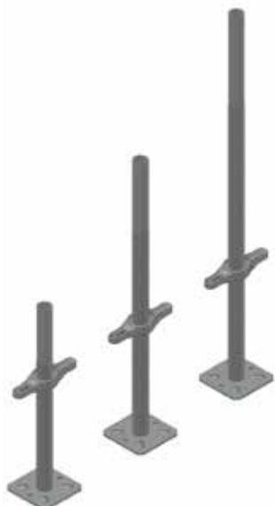
Fabriqués en acier zingué. Ils transmettent au sol les charges des cadres de l'échafaudage. La plaque d'appui renforcée a une épaisseur de 5 mm et une surface de 120x120 mm. Tige filetée de Ø 36 mm, disponible en différentes longueurs.
