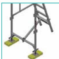
Il permet de donner l'inclinaison souhaitée à l'échelle du premier plancher d'accès, sans besoin d'utiliser des planchers en acier au niveau initial. Raccord sur le longeron à l'aide d'un collier pour tube rond. Il est galvanisé à chaud avec une épaisseur minimale de 75 microns.
