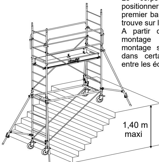
Pour un montage en dénivelé, il est impératif que les premiers barreaux d'échelles soient reliés par des diagonales comme précisé sur le schéma ci-dessous.
