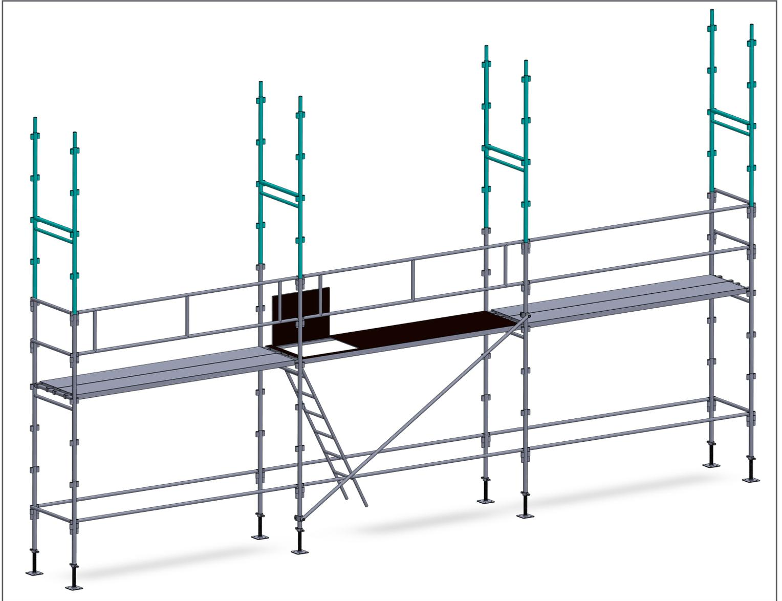
**ETAPE 9** : Placez ensuite les planchers 0,36 x 3 m et plancher trappe 0,75 x 3 m.
