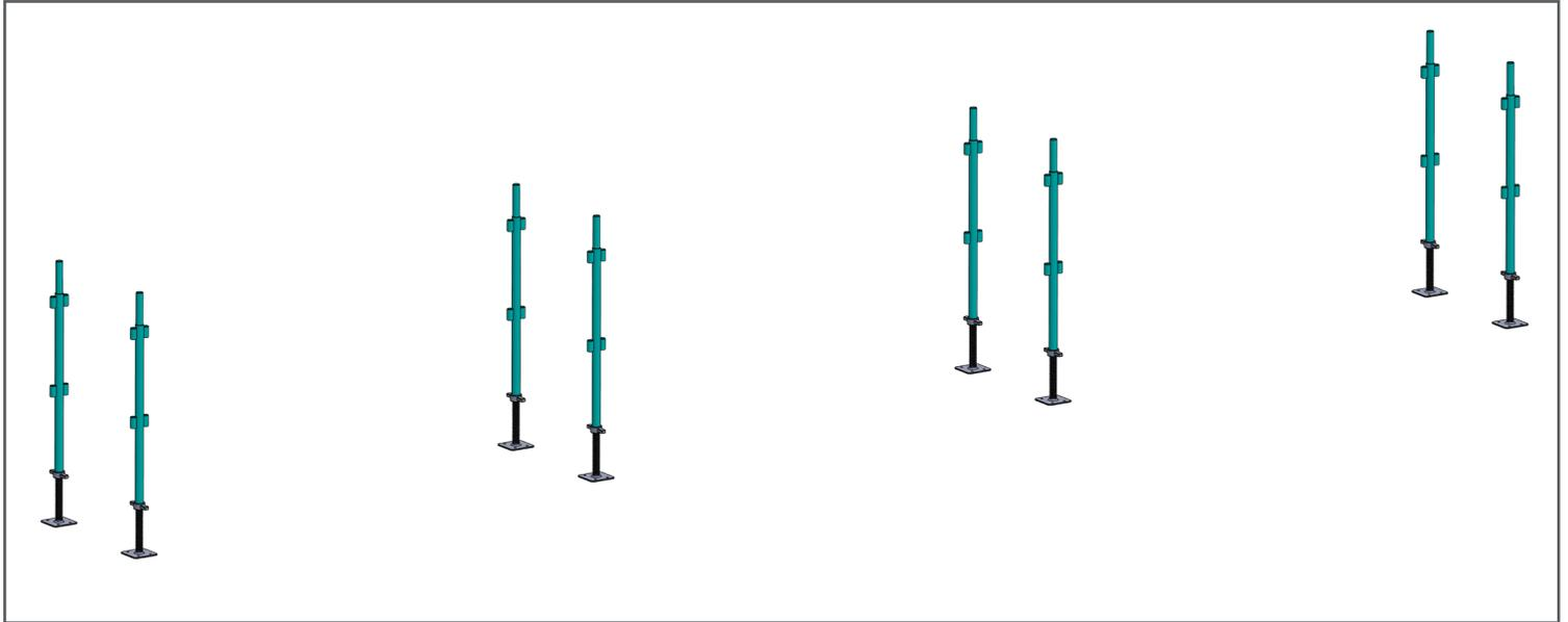
**ETAPE 3** : Placez les barres de lisse 3 m en longueur et les lisses d'extrémité 0,80 m en largeur.
