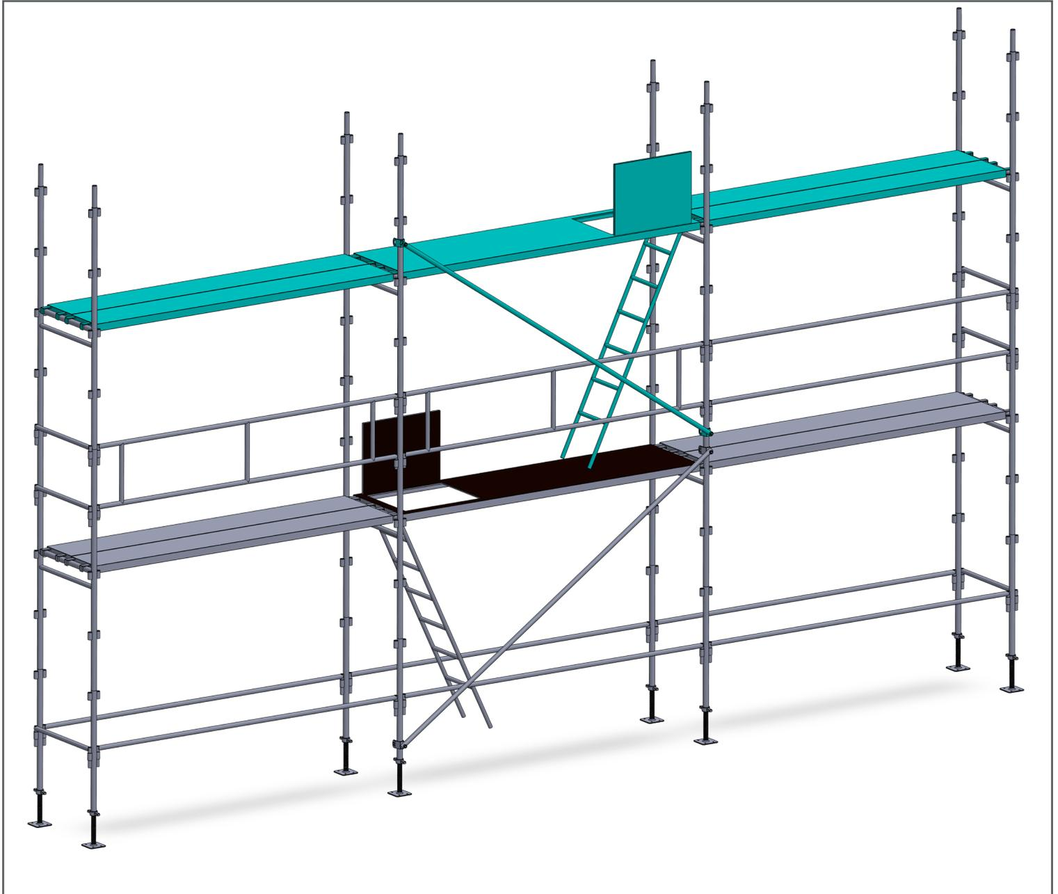
**ETAPE 10** : Terminez en plaçant les garde-corps 3 m ou barres de lisse 3 m (en fonction de votre configuration) en longueur et les lisses d'extrémité 0,80 m en largeur.
