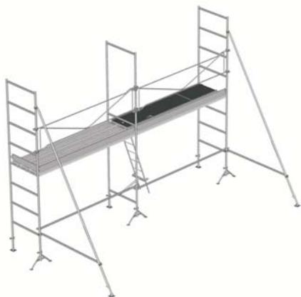
Continuer le montage des autres niveaux de travail en se référant au paragraphe 3 et aux points 1 et 2 du paragraphe 4. Terminer le dernier niveau de travail avec les cadres E1500B3 aux extrémités et les montants M1200 aux mailles intermédiaires.
