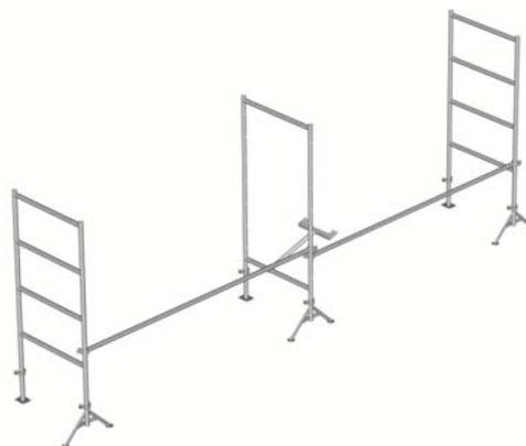
Placer les planchers fixes et le plancher à trappe, appuyer la première échelle d'accès sur le support.
