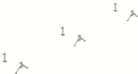
Monter les cadres E2000B4 aux extrémités et les cadres E2000B2T dans les mailles centrales. Relier les cadres avec les lisses et gardes corps. Dans la maille d'accès, placer un support d'échelle.
